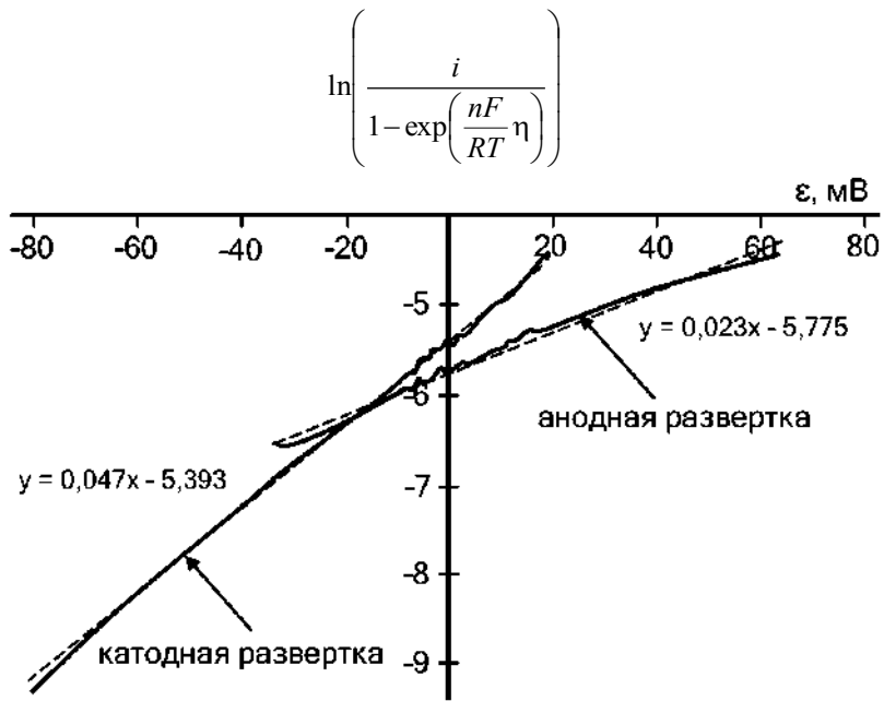
Рис. 6. Поляризационные кривые для 1 М хлорной кислоты с добавкой 1 \times 10^{-3} моль/л бензотриазола Fig. 6. Polarization curves for 1 M perchloric acid with the addition of 1 \times 10^{-3} mol/L of benzotriazole
