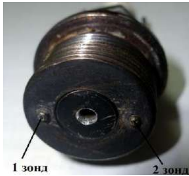
Рис. 3. Трехэлектродный ионизационный датчик
