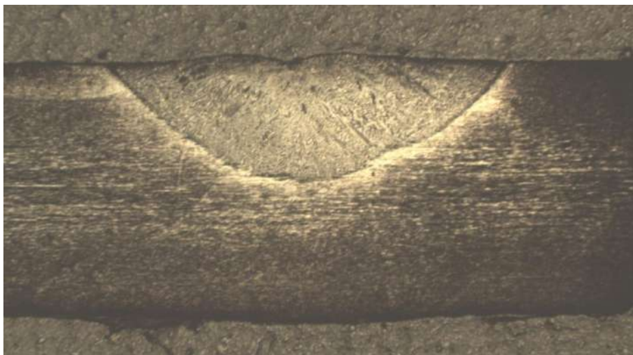
Рис. 2. Макрошлиф точки № 1, увеличение \times 20
